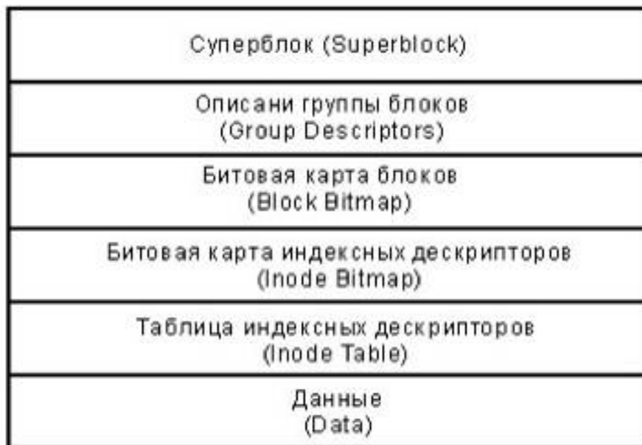
Рис. 16. Обобщенная структурная схема файловой системы ext2
