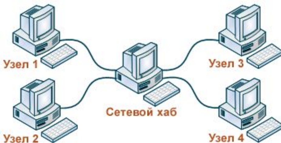
Рис.1. Топология типа «звезда»
