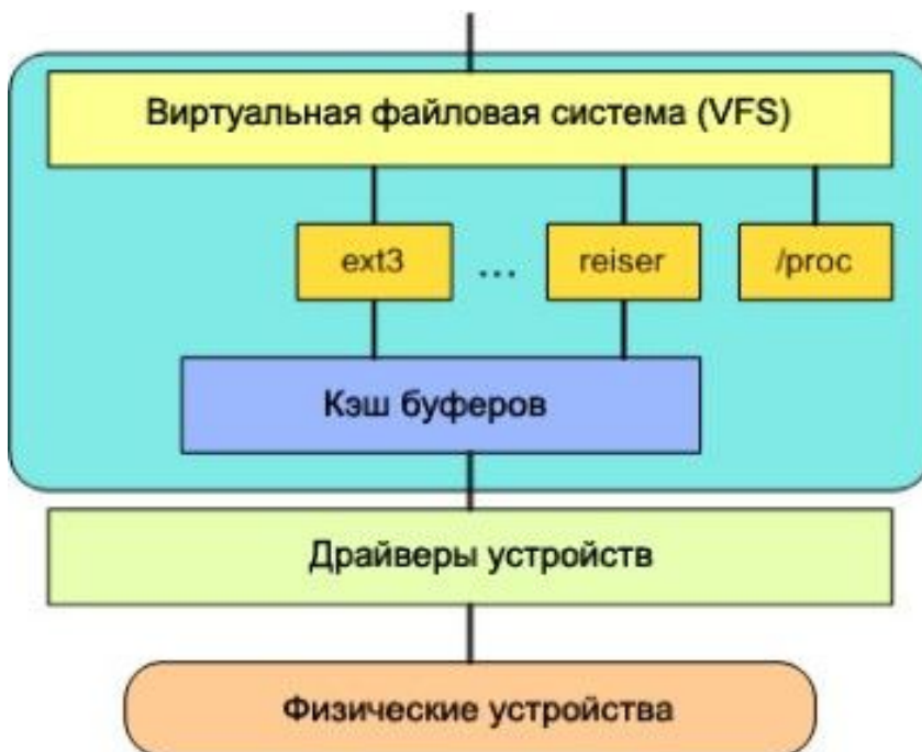
Рис. 13. Виртуальная файловая система
