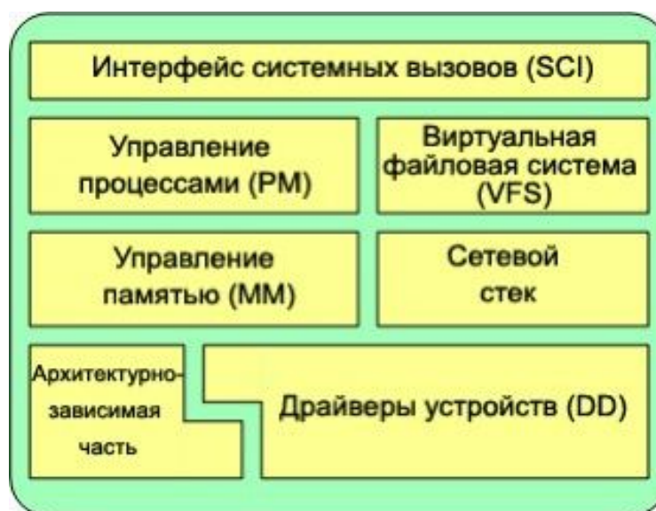
Рис. 12. Архитектура ядра Linux
